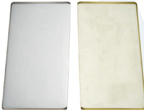
На фото показаны образцы компаунда СТЭП-ОП1 (слева) и компаунда другого производителя после выдержки в течение 2-х летних месяцев под открытым небом (июль и август 2023 года)
